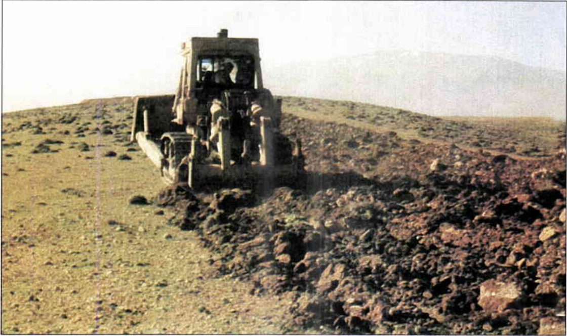
نقب التربة بواسطة الريزر
